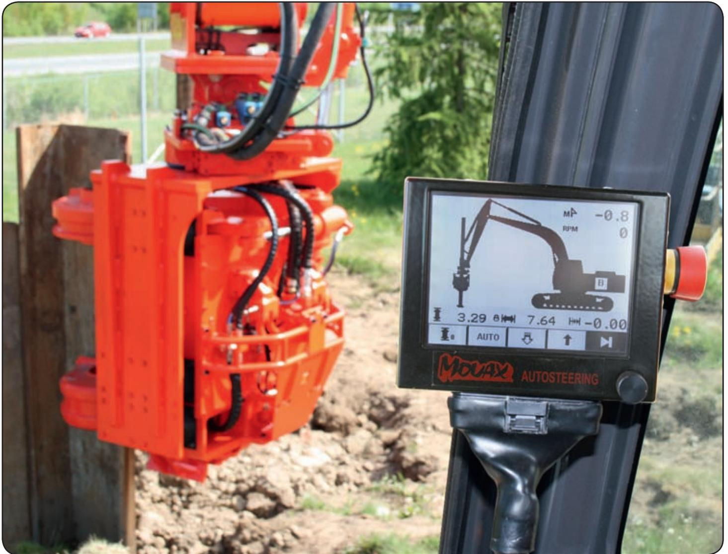
При погружении машинист экскаватора должен постоянно отслеживать вертикальность погружаемого элемента, используя линейные перемещения стрелой. Эта непростая задача требует одновременного управления тремя различными перемещениями трех гидроцилиндров: основной стрелы, рукояти стрелы и ковша. И в это же время из кабины экскаватора невозможно увидеть отклонение элемента от вертикали в плоскости продольной оси экскаватора.
